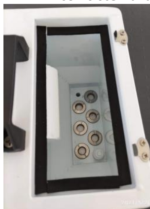
SERBATOIO dell'ATOMIZZATORE ASKYClean con sistema ad ULTRASUONI
